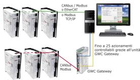
Controllo degli azionamenti tramite comandi da Controllore Master. Adatto per Sistemi Multiasse. Integra tutte le Funzionalità del Modulo Power Motion che assicura perfetta sincronia tra gli Assi e Riduce il carico di Lavoro del Controllore Master.
