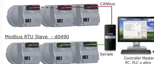
Controllo degli azionamenti tramite comandi da Controllore Master. Adatto per Sistemi Multiasse (fino a 127 azionamenti). Integra tutte le Funzionalità del Modulo Power Motion che assicura perfetta Sincronia tra gli Assi e Riduce il carico di Lavoro del Controllore Master.
