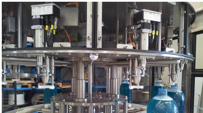
Un primo traguardo della collaborazione tra Ever Elettronica ed Enoberg: riempitrice a giostra singola con gli azionamenti integrati della serie SM1A di Ever Elettronica, applicati direttamente al dosatore.
