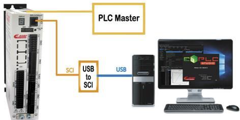
Gestione autonoma del firmware per l'esecuzione dell'**homing**, del movimento a target con quote relative o assolute e per la generazione dei profili di rampa
